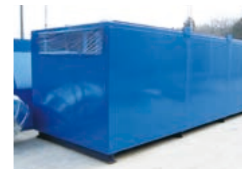
活性炭吸着塔10m³
